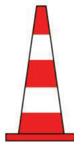
K5a Balise de chantier.
