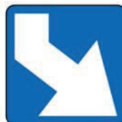
J5 AUTO RELEVABLE Signalisation des têtes d'îlots directionnels à contournement par la droite.
