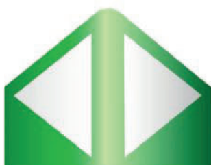
J14 Balise de musoir, signalant la divergence des voies.
