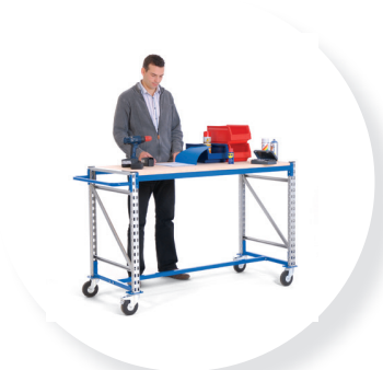
4 Établi roulant. Charge 250 kg Structure roulante + plateau. 1 poignée de manutention. 4 roulettes pivotantes dont 2 à blocage (une par échelle). Roues ø 125 mm à bandage caoutchouc. Hauteur dessus plateau : 1010 mm.
